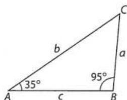
$$\frac{a}{\sin 35^\circ} = \frac{b}{\sin 95^\circ} \Rightarrow \frac{a}{\sin 35^\circ} = \frac{38 - a}{\sin 95^\circ}$$
