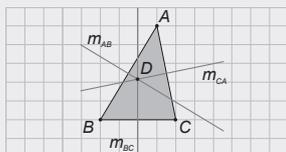
El punto  $D$  es equidistante de los vértices del triángulo. Así, el lugar geométrico de los puntos equidistantes del punto  $D$  y que contiene los vértices del triángulo es la circunferencia de centro
